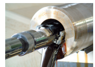
Panzerung der ganzen Schneckenoberfläche
