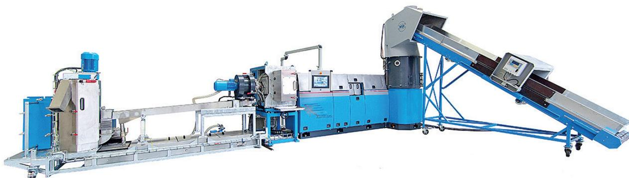
Наши линии благодаря своей гибкости могут перерабатывать широкую шкалу пластиковых отходов, в частности PE, PP пленки и твердый пластиковый PP, PE, PS, ABS лом и прочее. Все модели MARATHON LINE управляются самой современной ПЛК системой управления, которая дает множество различных пользовательских настроек, включая сохранение рецептов, пользовательских прав, дистанционный доступ и прочее.
